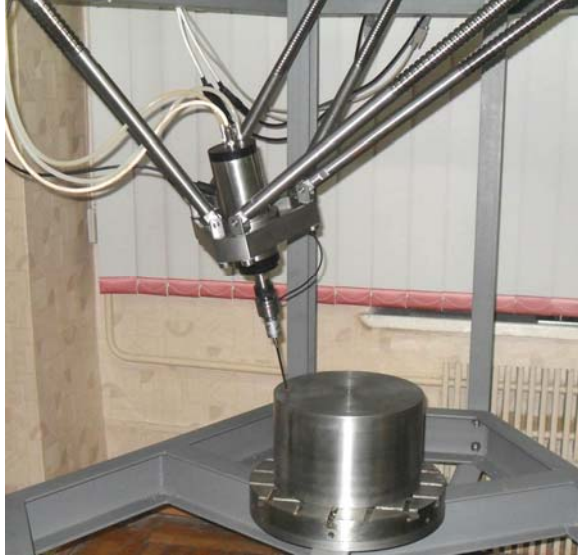
Рисунок 3 – Вимірювання оправки на верстаті
