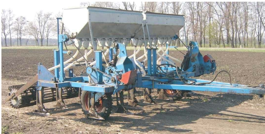
Рисунок 1 – Загальний вигляд дослідного зразка машини КРУ-4 з експериментальними робочими органами для підґрунтового внесення мінеральних добрив та прямої сівби зернових культур
