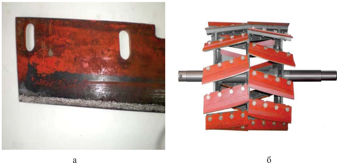
Рисунок 3 – Нож (а) измельчающего барабана (б) комбайна
