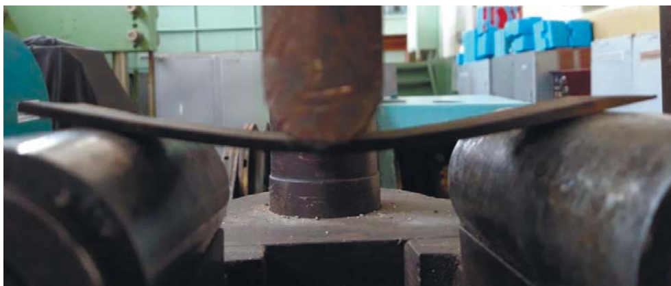
Рисунок 1 – Прогин зразків зі сталі марки 30MnB5 під навантаженням
