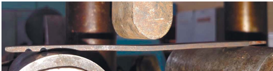
Рисунок 3 – Вихідне положення зразків дисків сошника після зняття навантаження, температура відпускання – 380^{\circ}\text{C}
