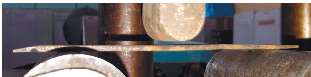
Рисунок 2 – Вихідне положення зразків зі сталі марки 30MnB5 після зняття навантаження, температура відпускання – 180° C
