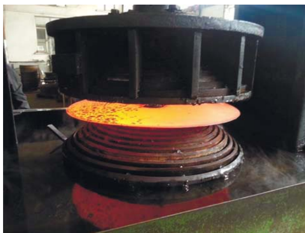
Рисунок 5 – Загальний вигляд гартувального штампа для виробництва увігнуто-опуклих сферичних дисків
