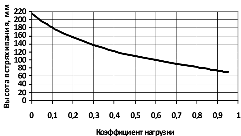
Рисунок 7 – Зависимость полного хода поршня (высоты встряхивания) от коэффициента нагрузки для клапанного и золотникового механизмов
