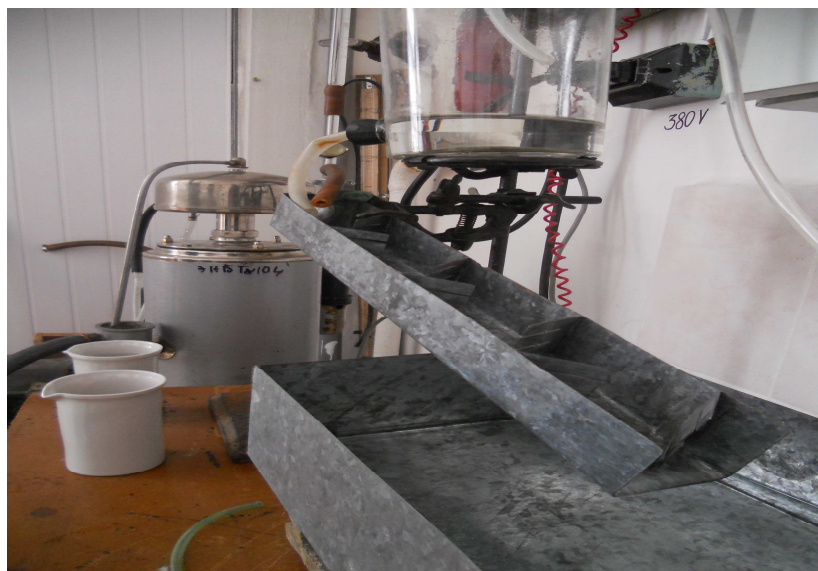
Рисунок 2 – Фото експериментальної установки з камерою перемішування, обладнаної відбиваючими перегородками
