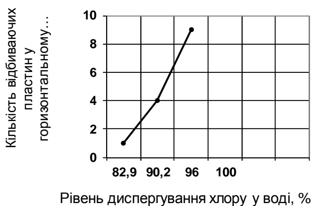
Рисунок 4 – Залежність рівня диспергування хлору у воді від кількості відбиваючих пластин у горизонтальному жолобі
