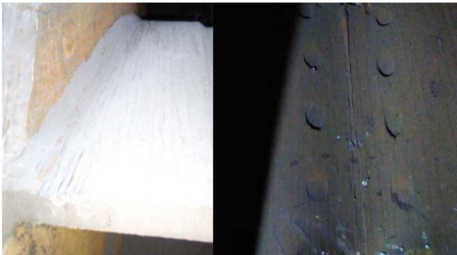
Рисунок 1 – Результат газоабразивного зносу колеса робочого нагнітача Н9000
