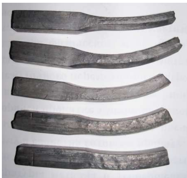
Рисунок 4 - Образцы-недокаты, заторможенные в валках
