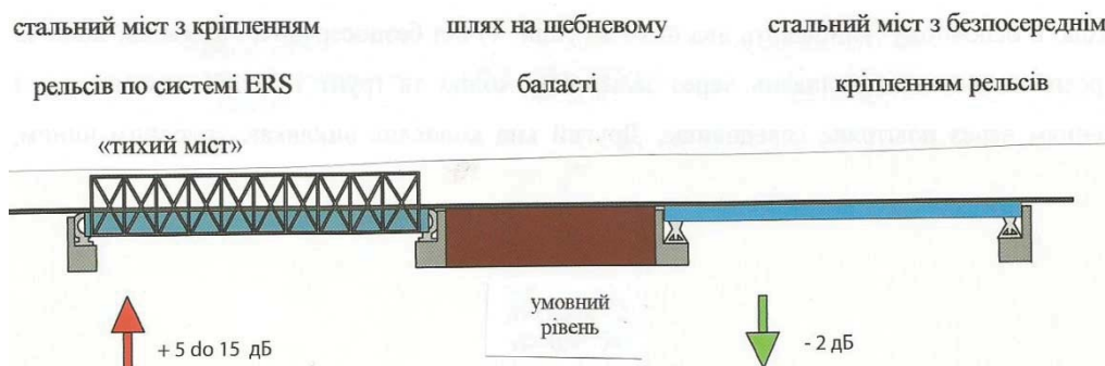
Рис. 4. Емісія шуму на мостах: традиційний міст з підвищеною емісією шуму, редукція шуму на «тихому» мості [12]
