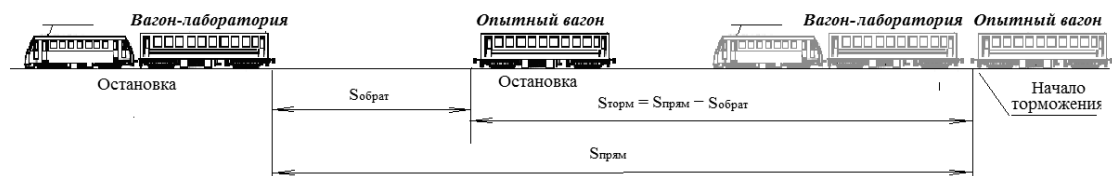
Рис. 1. Определение тормозного пути опытного вагона методом «бросания»
