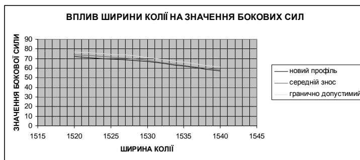
Рис. 7. Вплив ширини колії на значення бокових сил
