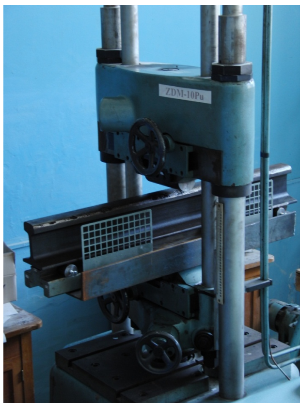
Рис. 3. Загальний вигляд випробувальної установки із встановленим зразком рейки
