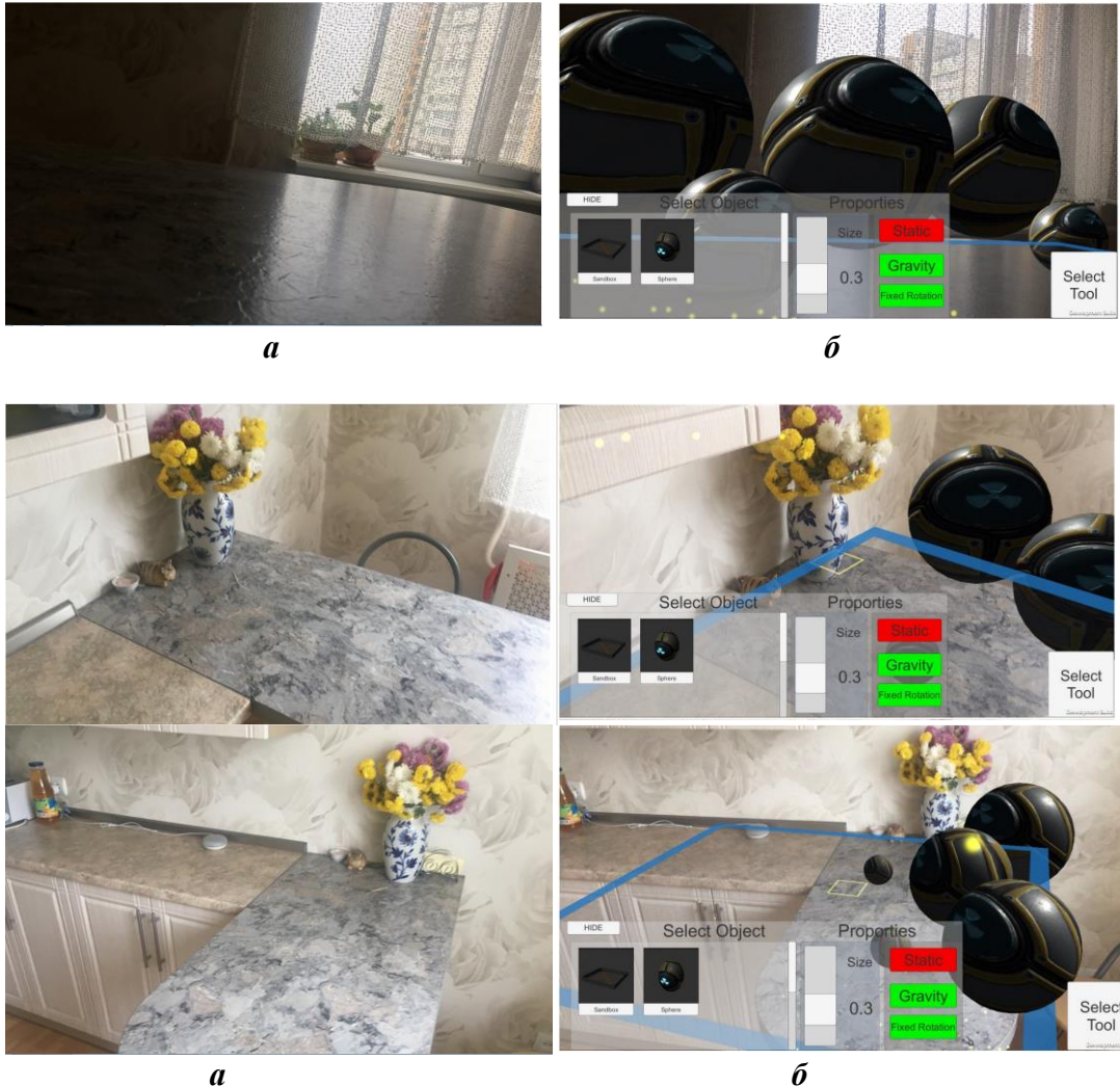
Рис. 4. Вигляд реального простору (а) та простору з використанням доповненої реальності (б). На нижньому рисунку (а) імітовано дію гравітації
