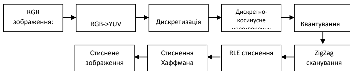
Рис. 2. Схема алгоритму стиснення зображень JPEG (Джерело: [7])
