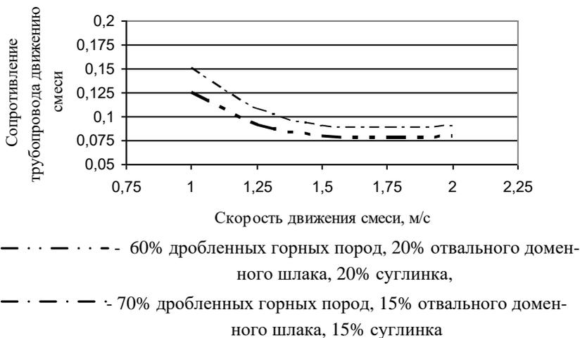
**Рис. 4** Изменение сопротивления трубопровода движению смеси при увеличении дробленных горных пород с 60% до 70% за счет снижения с 20% до 15% количеств отвального доменного шлака и суглинков
