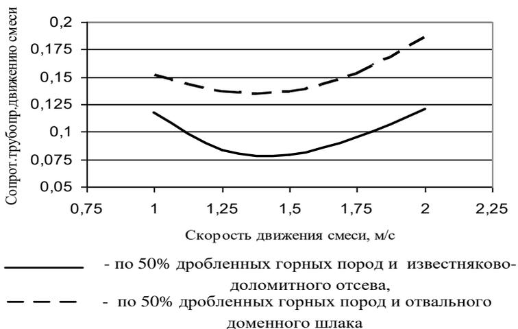
**Рис. 1** Изменение сопротивления трубопровода движению смеси при замещении известняково-доломитного отсева отвальным доменным шлаком
