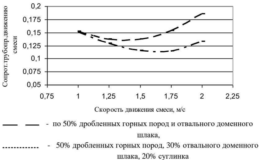
**Рис. 2** Изменение сопротивления трубопровода движению смеси при замещении 20% отвального доменного шлака суглинком
