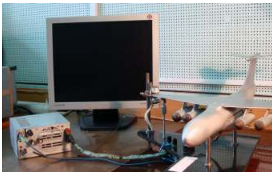
Рис. 2. Підключення збудника коливань до макету літака
