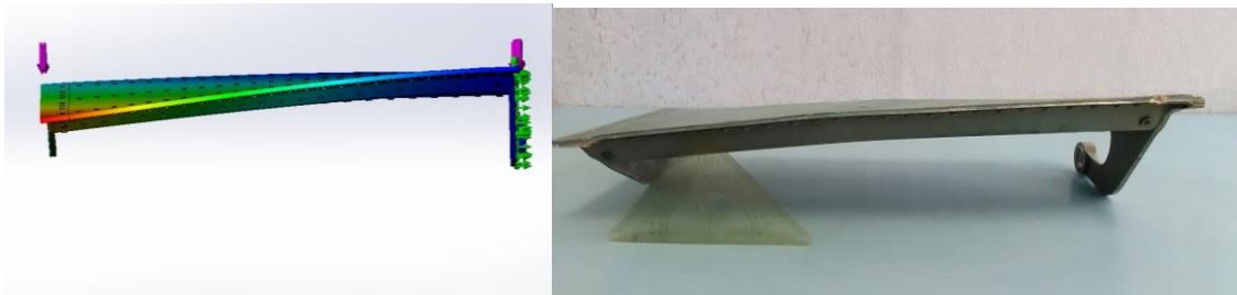
Рис. 4. Деформація (переміщення) математичної моделі і натурального об'єкта
