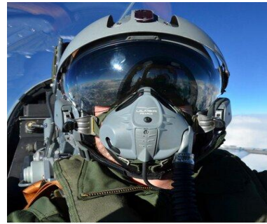
Рис. 5. Зовнішній вигляд ЗШ MSA LA 100 виробництва “MSA GALLET” з КМ UA 21S виробництва “ULMER AERONAUTIQUE” (Франція)
