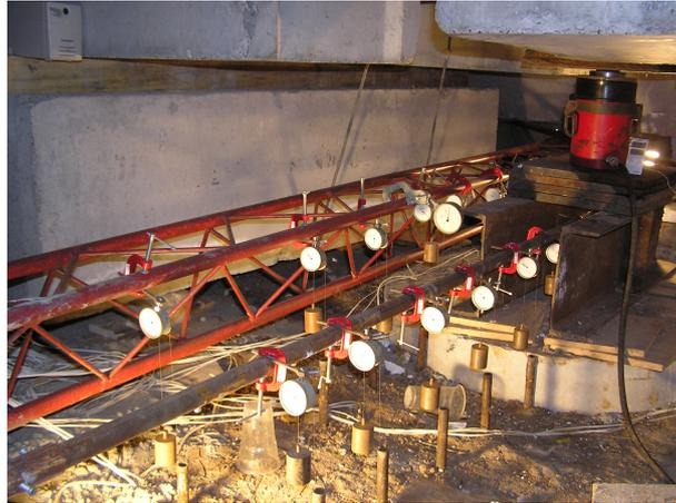
Рис. 2. – Общий вид круглого штампа, домкрата и измерительных устройств
