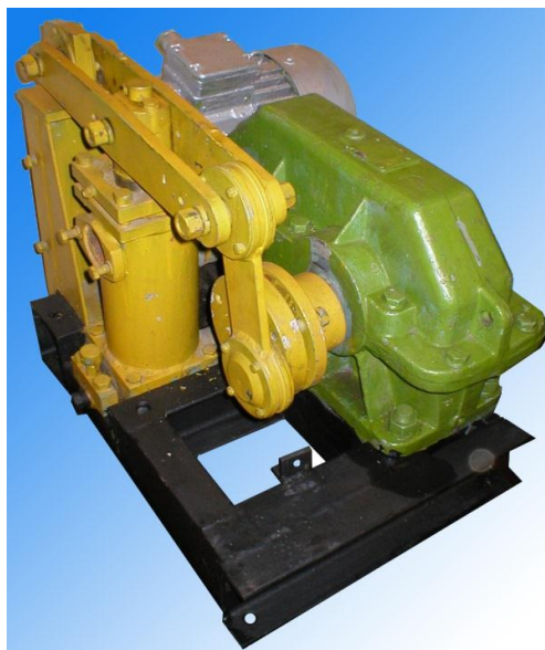
Рисунок 5 – Диференціальний розчинонасос РН 2-4 М
