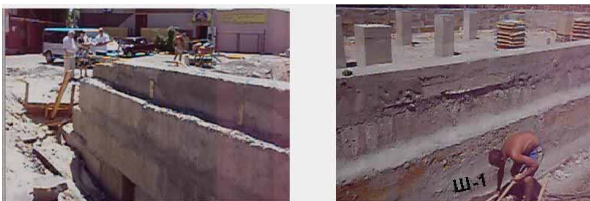
Рисунок 2 – Общий вид участка и отбор монолитов под фундаментом из шурфа (Ш-1)
