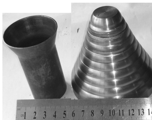
Рис. 11. Zдеформована заготовка та зпрофільований конусний пуансон
