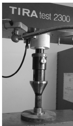
Рис. 9. Оснащення на випробувальний стенді TIRA test 2300
