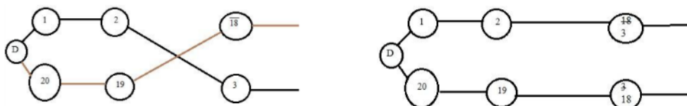
Рис. 3. Заміна перехрещень алгоритмом 2-орт, для зменшення кінцевої відстані
