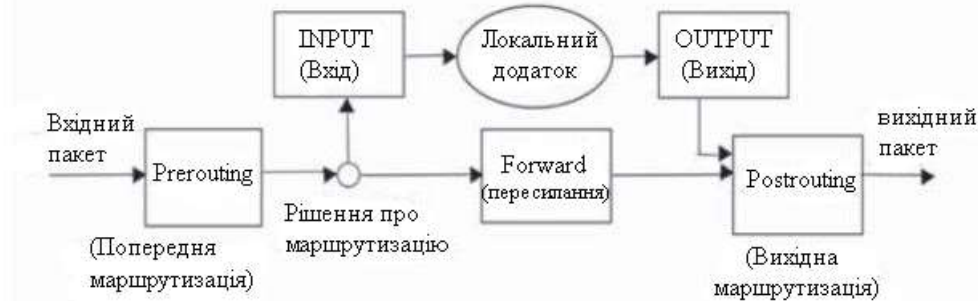
Рис. 4. Схема проходження пакетом ланцюжка фільтрів в Linux-маршрутизаторі
