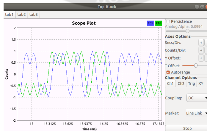
Рисунок 12б – Відображення форми сигналу у часовій області після модуляції
