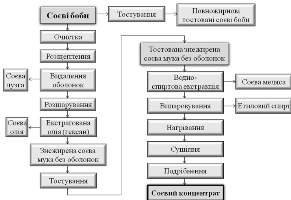
Рис. 3 – Принципова схема виробництва соєвого концентрату
