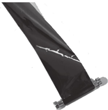
Рис. 17. Концевик на ленте картриджа Ultrium LTO-2
