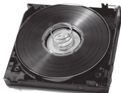
Рис. 16. Внешний вид (а) и устройство (б) картриджа Ultrium LTO-2
