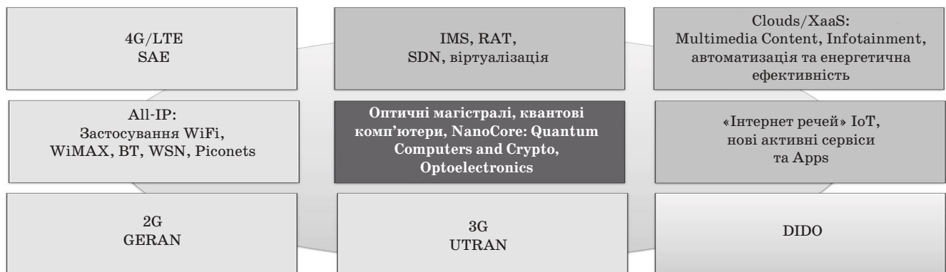
Рис. 8. Архітектура систем мобільного зв'язку покоління 5G
