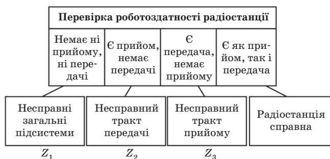
Рис. 2. Алгоритм діагностування радіостанції
