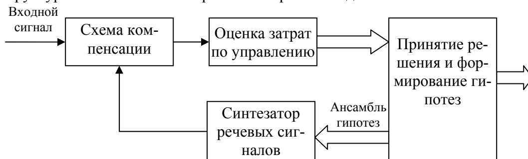
Рис. 6 Обобщенная структурная схема системы на основе принципа компенсации
