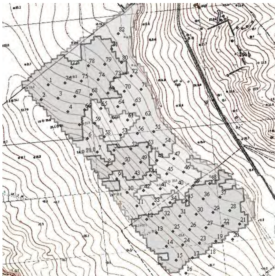
Рис. 1. Розміщення ґрунтових виділів та точок відбирання проб ґрунту на полігоні «Крим-Кам'янка» (топографічна основа масштабу 1:10 000)
