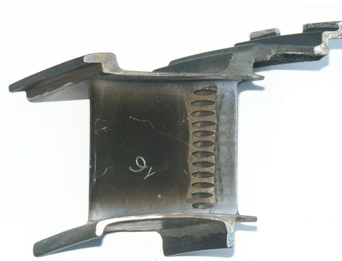
Рис. 2. Модернизированная конструкция лопатки СА
