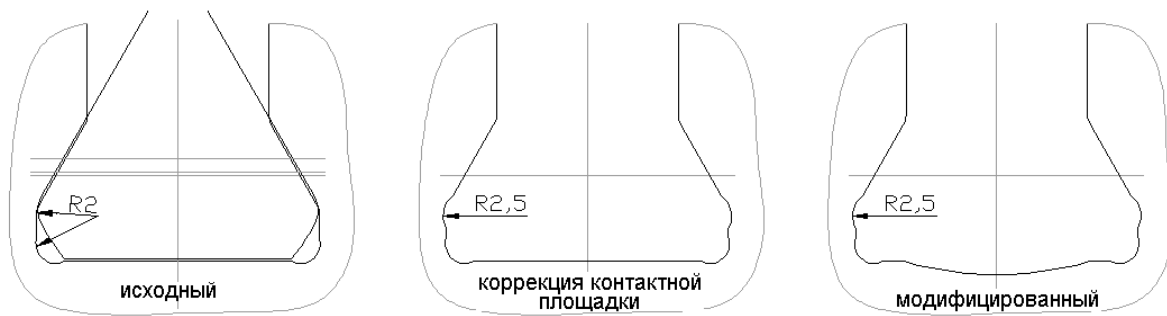
Рис. 3. Вид последовательного введения в профиль паза конструктивных изменений
