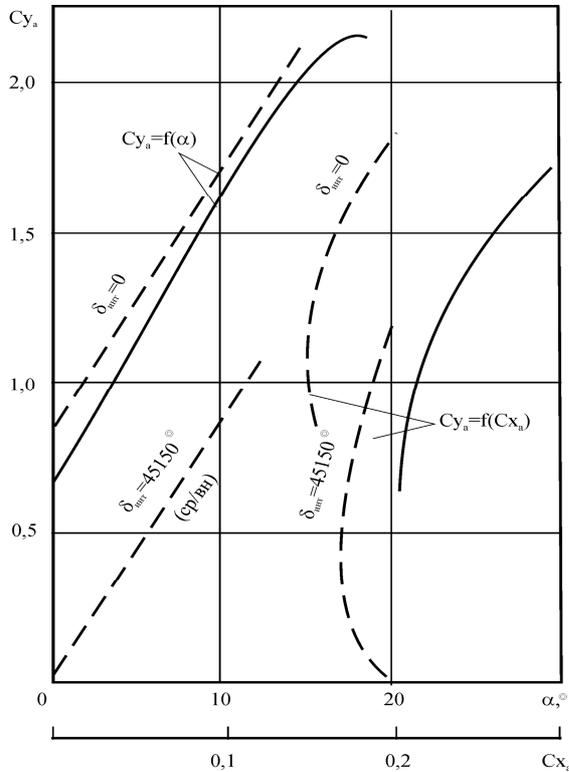
Рис. 4. Влияние крыльевых интерцепторов на изменение зависимостей  $C_y(\alpha)$  и  $C_y=f(C_x)$  самолета Ту-154Б ( $\delta_{инт.}=45^\circ$ , предкрылки и шасси выпущены): — без учета влияния земли; - - - с учетом влияния земли
