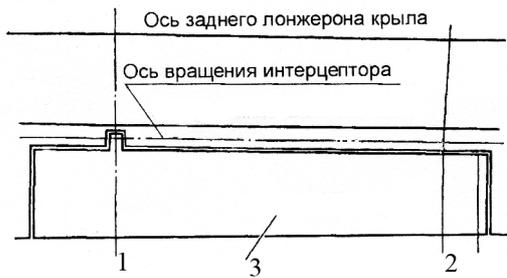
Рис. 3. Конструктивное исполнение интерцептора на крыле самолета Ан-140:
