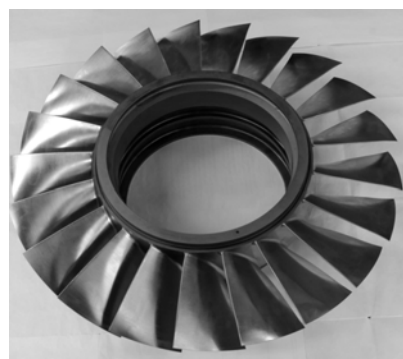
Рис. 1. Осевое моноколесо КНД
