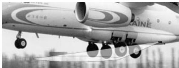
Рис. 2. Посторонний предмет в габарите шасси
