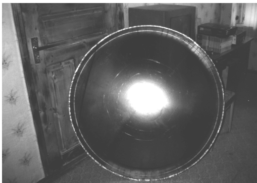
Рис. 3. Деталь, отштампованная из сварной заготовки, сталь 08кп
