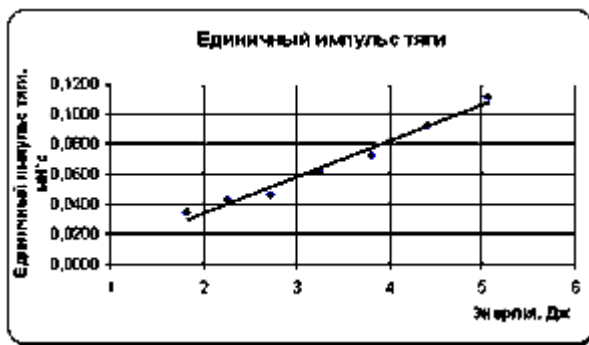
Рис. 2. Зависимости КПД и единичного импульса тяги от запасаемой энергии
