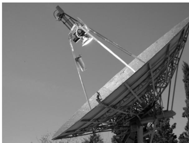
Рис. 1. Ресурсные испытания металлической тепловой защиты на установке СГУ-7
