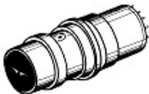
Рис. 2. Внешний вид серийного гироскопического датчика угловых скоростей класса ДУСУ2-6АС
