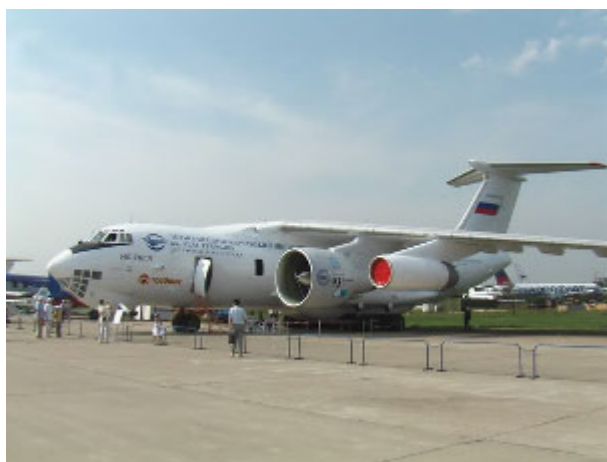
Рис. 7. Летающая лаборатория ИЛ-76ЛЛ с двигателем НК-93
