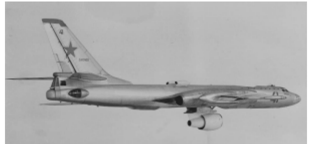
Рис. 3. Летаящая лаборатория Т-16ЛЛ с опытным двигателем Д-36
