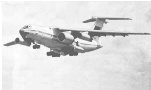
Рис. 5. Летающая лаборатория Ил-76ЛЛ с двигателем Д -18Т
