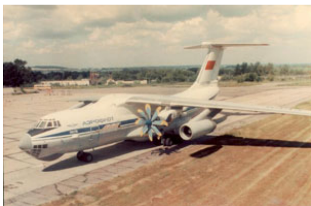
Рис. 6. Летающая лаборатория ИЛ-76ЛЛ с двигателем Д-27
