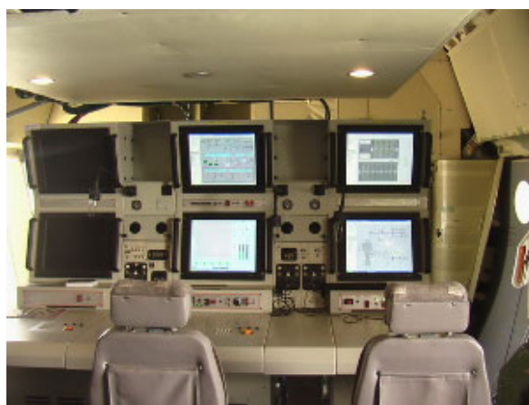
Рис. 9. Пульт управления летным экспериментом в грузовой кабине ИЛ-76ЛЛ
