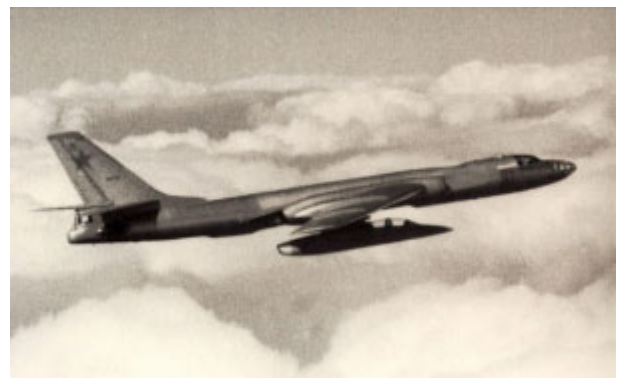
Рис. 4. Летаящая лаборатория Ту-16ЛЛ с опытной силовой установкой самолета L-36 с двигателем ДВ-2
