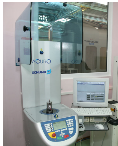
Рис. 13. Балансировочный станок ACURO для балансировки инструмента
