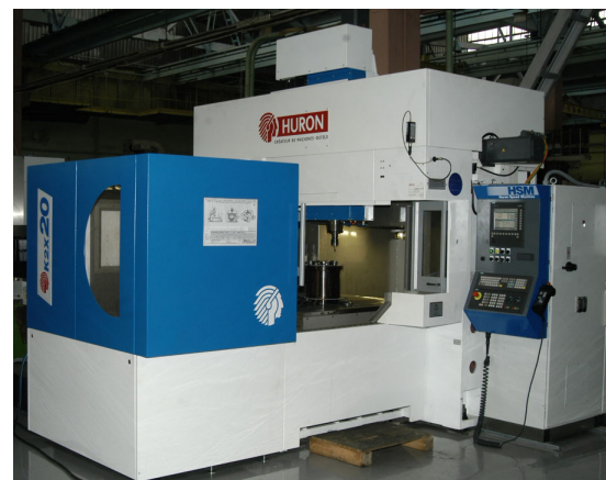
Рис. 2. Фрезерный 3-х координатный обрабатывающий центр K2X20
