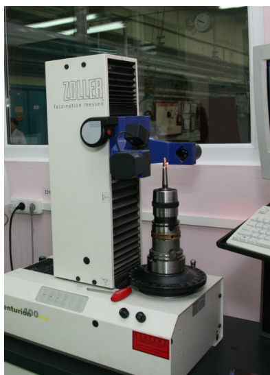
Рис. 12. Микроскоп ZOLLER для настройки осевого инструмента
