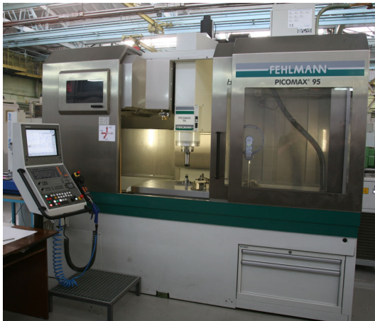
Рис. 9. Фрезерный 3-х координатный обрабатывающий центр PICOMAX-95
