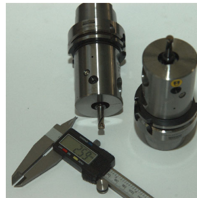
Рис. 11. Высокоточная расточная оснастка фирмы SANDVIK
