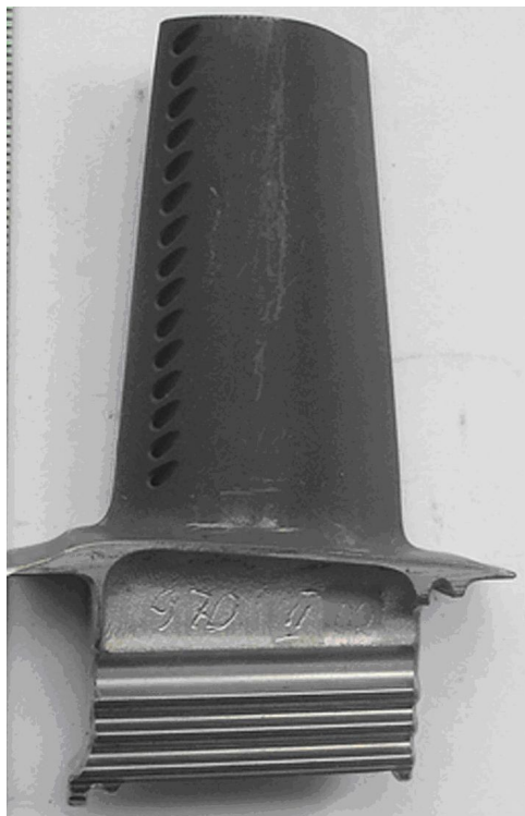
Рис. Внешний вид охлаждаемой монокристаллической лопатки 1-й ступени ТВД
