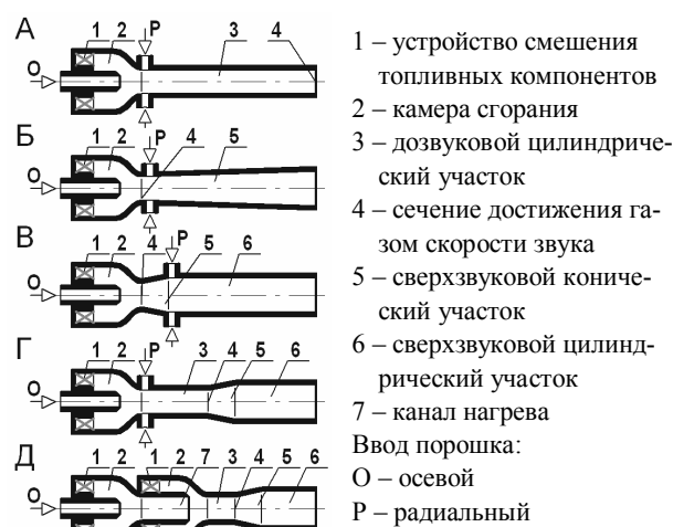
Рис. 1. Схемы сопловых каналов горелок для ВГПН и места ввода в них напыляемого материала
