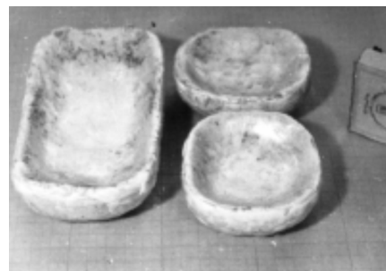
Рис. 5. Опытные образцы кюветы объёмом 100 \text{ см}^3 и тиглей объёмом 30 \text{ см}^3 из кварцевой керамики с покрытием из \text{Nb}_2\text{O}_5
