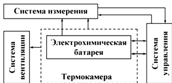
Рис. 8. Стенд для ускоренных ресурсных испытаний электрохимических аккумуляторов и батарей большой емкости
