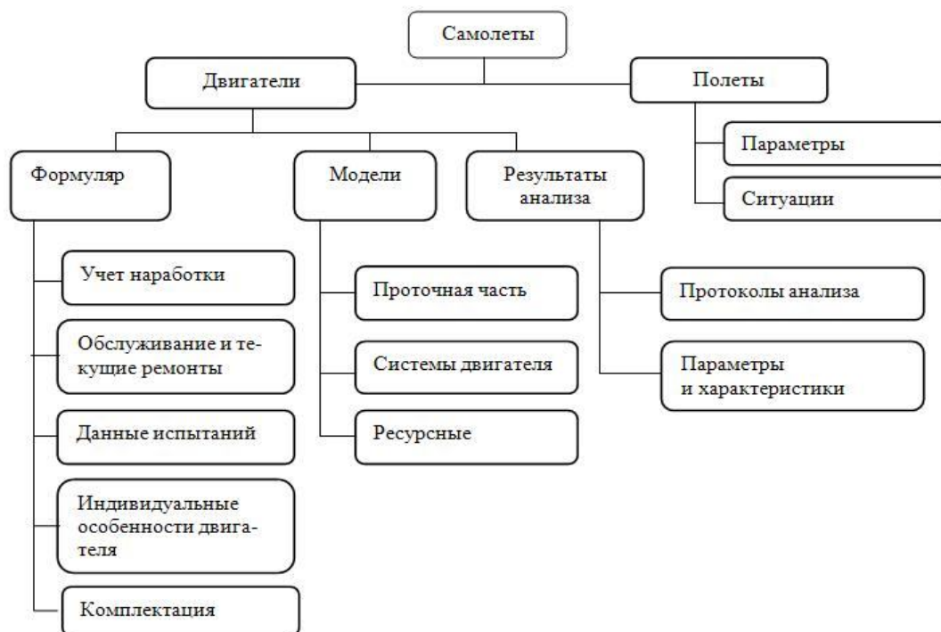
Рис. 7. Структура базы данных комплекса «Диагностика Д-18Т»
