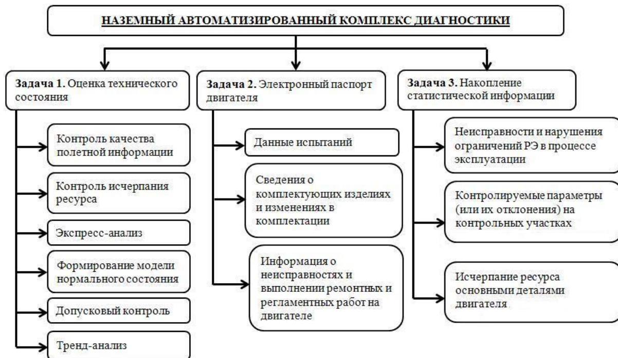
Рис. 1. Структура комплекса «Диагностика Д-18Т»
