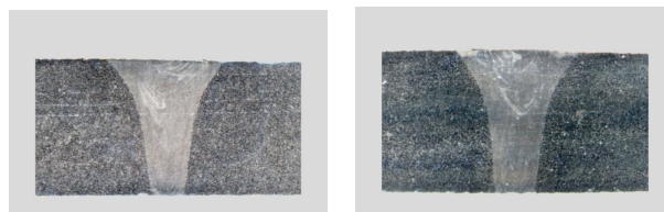
Рис. 3. Макроструктура сварного соединения магниевого сплава МЛ10 толщиной \delta_m = 6 мм при сварке по схеме снизу-вверх а - I_p = 35 А; б - I_p = 40 А
