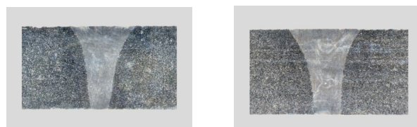
Рис. 4. Макроструктура сварного соединения магниевого сплава МЛ10 толщиной \delta_m = 6 мм при сварке по схеме сверху-вниз а - I_p = 35 А; б - I_p = 40 А
