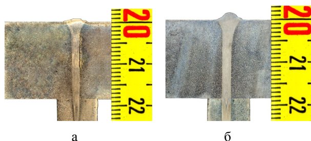
Рис. 6. Макроструктура сварного соединения магниевого сплава МЛ10 толщиной \delta_m = 18,5 мм: а - без обработки методом FSW; б - с обработкой методом FSW
