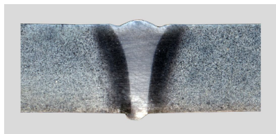
Рис. 2. Макроструктура сварного соединения магниевого сплава МЛ10 толщиной \delta_m = 8 мм при сварке в нижнем положении
