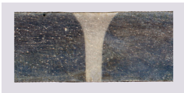
Рис. 1. Макроструктура сварного соединения магниевого сплава МА2-1 толщиной \delta_m = 5,5 мм при сварке в нижнем положении
