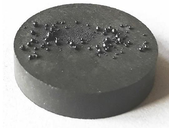
Рис. 7. Внешний вид тыльной стороны образца 3.1 КК состава № 1 после первого цикла нагрева при температуре поверхности 1400^\circ C
