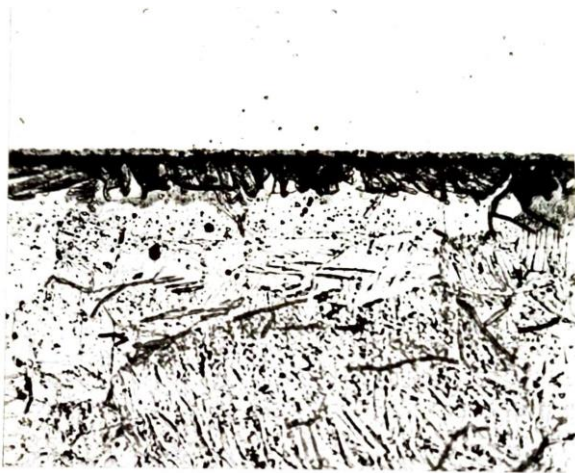
Рис. 2. Мікроструктура дифузійної зони з'єднання платина-титан, x500
